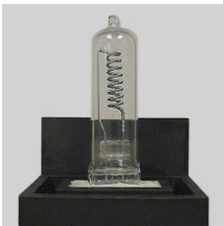
Abb. 1: (linkes Bild) Einseitig gesockelte 1000W Halogenlampe mit ähnlichster Farbtemperatur von ca. 3200K. Die Lichtabgabe wird durch thermische Aufheizung der Glühwendel infolge Stromfluß erzeugt.
